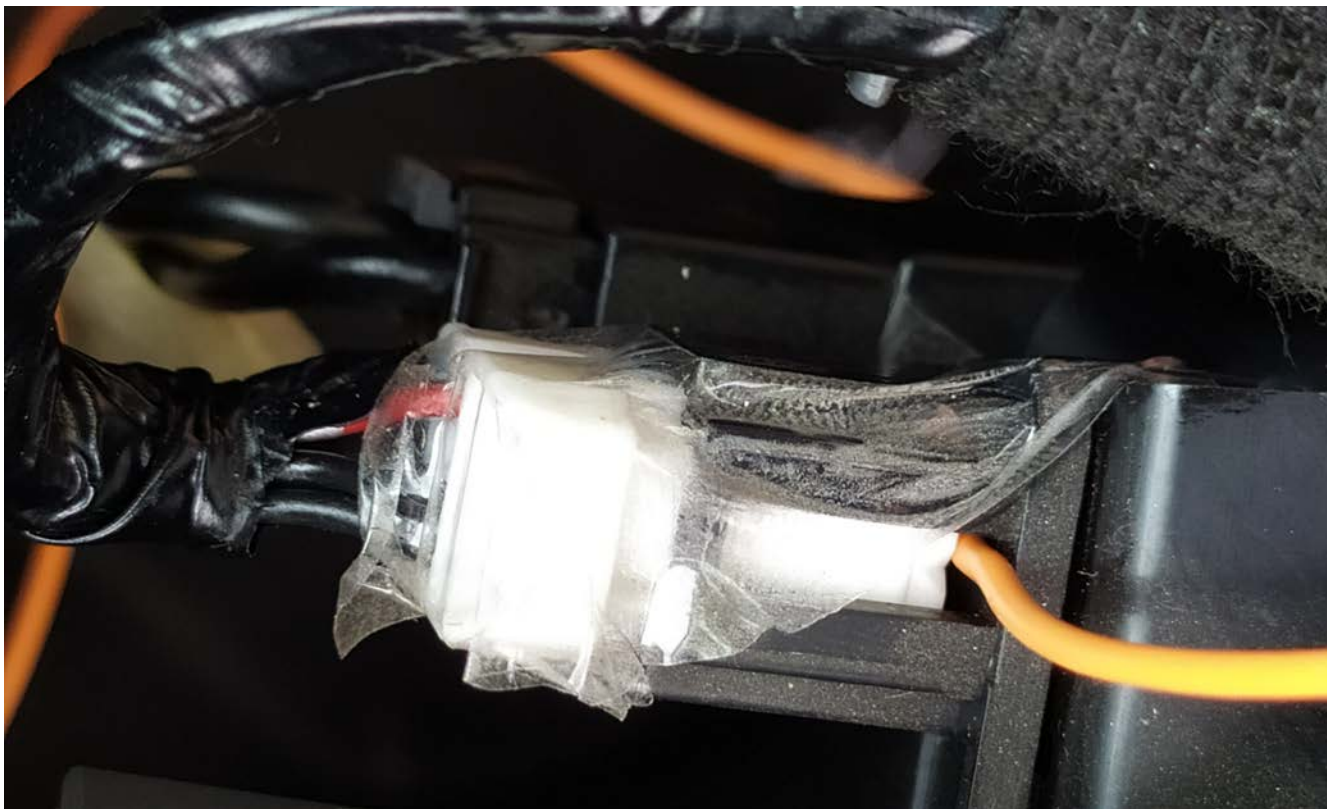
фото 08 - Колодка мешает фиксироваться наш провод, крепим скотчем.
