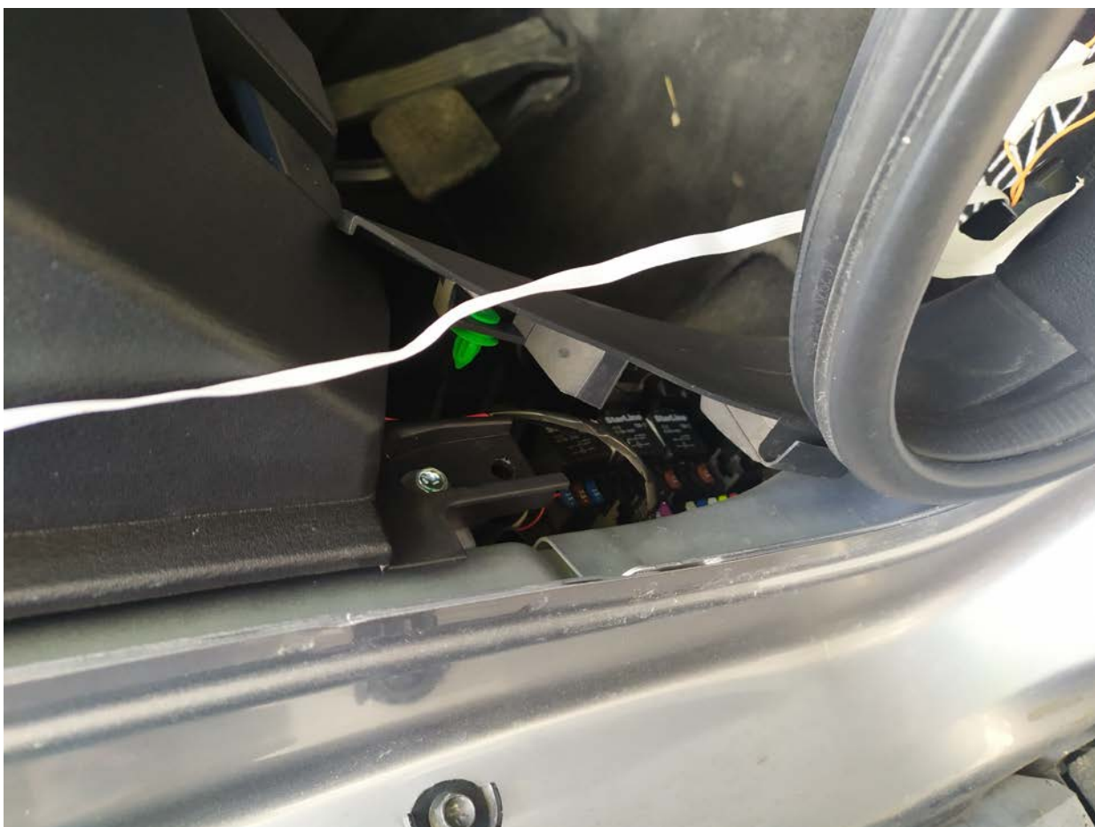
фото 02 - Отвели накладку стойки, она на клипсе. Извлекаем заглушку из панели приборов.
