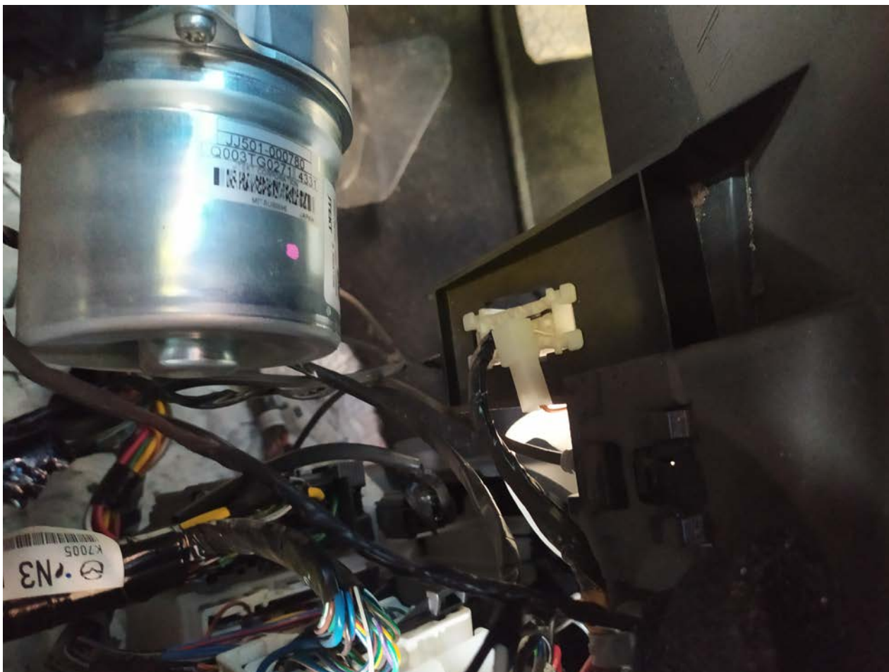
фото 04 - Вид на колодку обд2 сверху через отверстие заглушки
