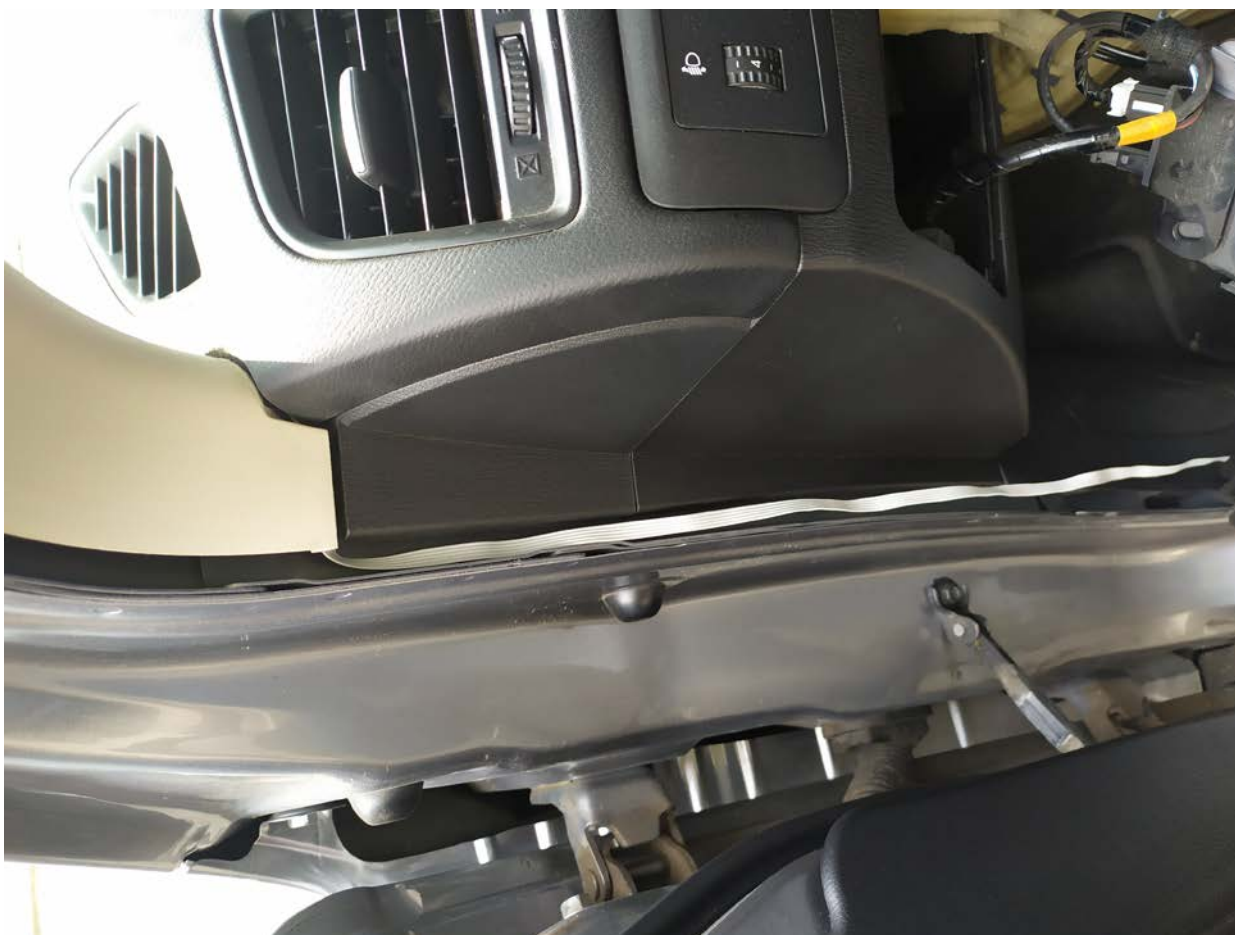
фото 02 - Отвели накладку стойки, она на клипсе. Извлекаем заглушку из панели приборов.
