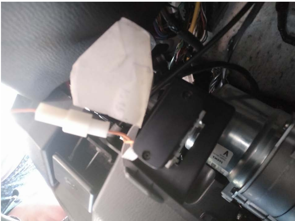
фото 04 - Вид на колодку обд2 сверху через отверстие заглушки
