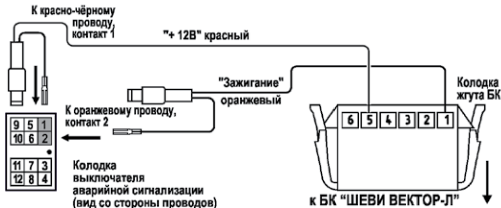
Рис. 9 Схема подключения жгута №2 для а/м с БКЛ АБС и ПБ после 08.2011 г.
