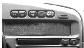
Рис.8 БК установлен ("САМАРА - 2")
