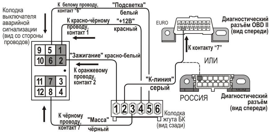
Рис.12 Схема подключения ("CHEVI-NIVA")
