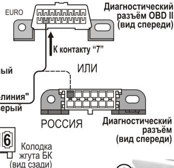
Рис.5 Схема подключения ("САМАРА - 2")
