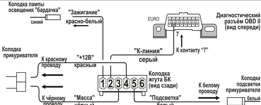
Рис.1 Схема подключения ("BAZ 2110")
