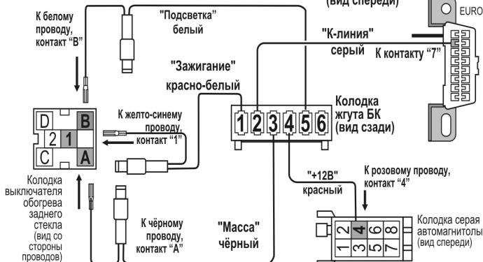
Рис.3 Схема подключения БК "ШТАТ Х1-Р"
