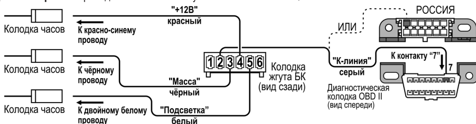
Рис.2 Схема подключения БК
