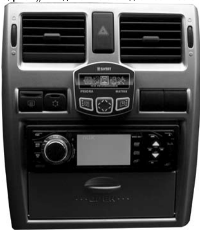
Рис. 12 Вид установленного БК
